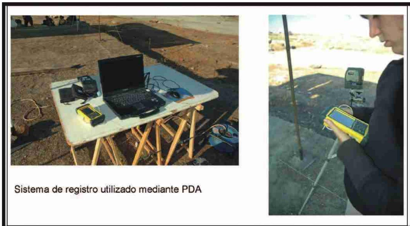
Figura 3. Sistema de registro informatizado de recogida y procesamiento de datos "3 Coord".
